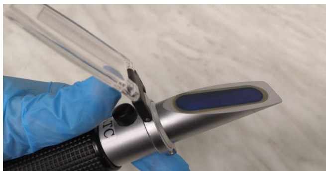
Рисунок 2 – Рефрактометр для определения плотности мочи
