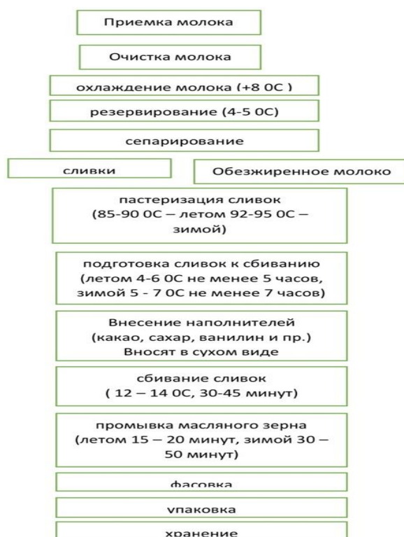
Рисунок 1 - Технологическая схема производства шоколадного масла методом преобразования высокожирных сливок
