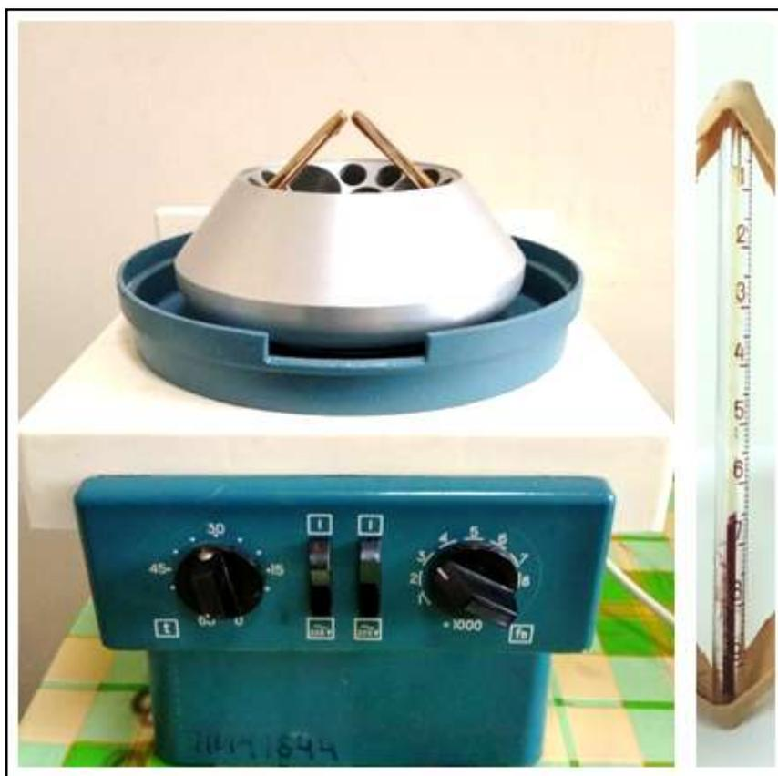
Рисунок 17. Определение гематокритной величины путем центрифугирования в гематокритной трубке
