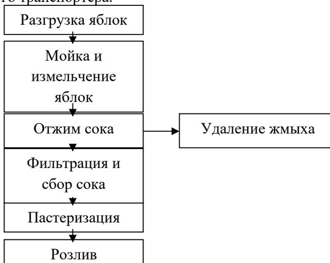
Схема -1 технологические этапы производства яблочного сока прямого отжима.
