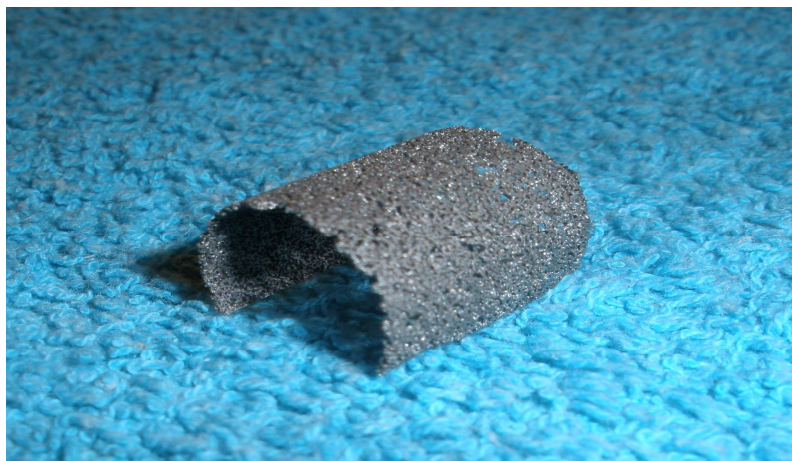
Рисунок 1. Мембрана из пористого никелида титана, изготовленная по форме альвеолярного гребня
